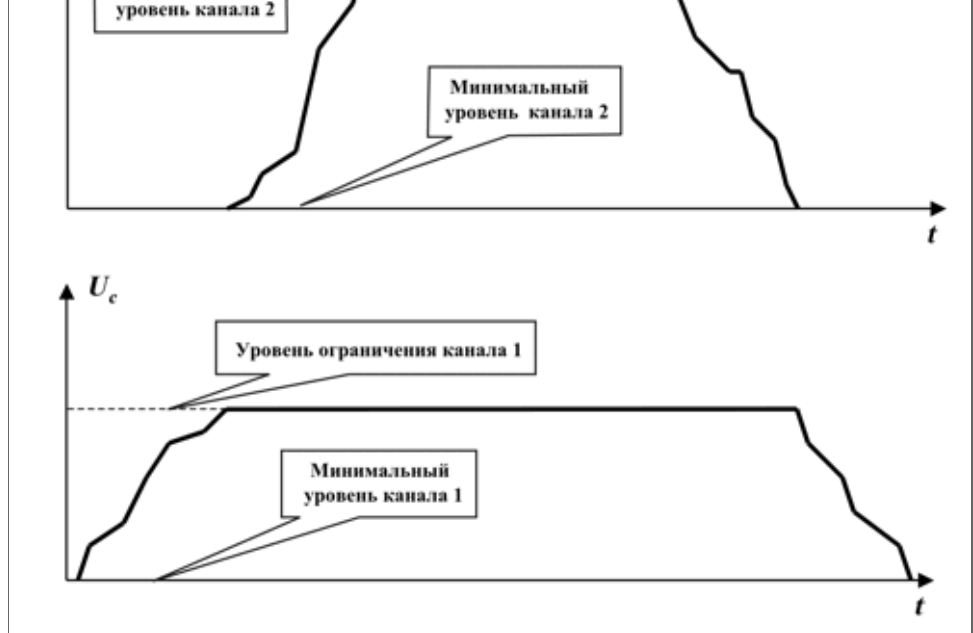
Рис. 3. Иллюстрация разделения диапазона освещенностей на два канала
